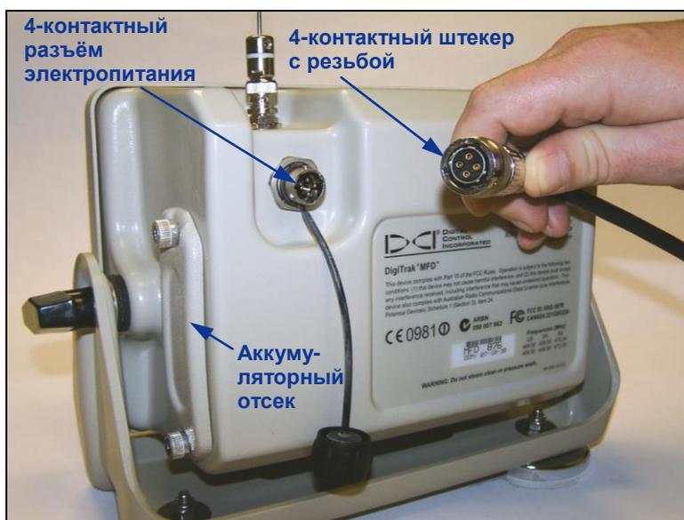
**Подключение кабеля постоянного тока**
