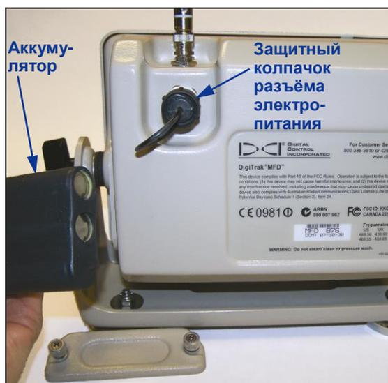
**Установка аккумулятора DCI NiCad**
