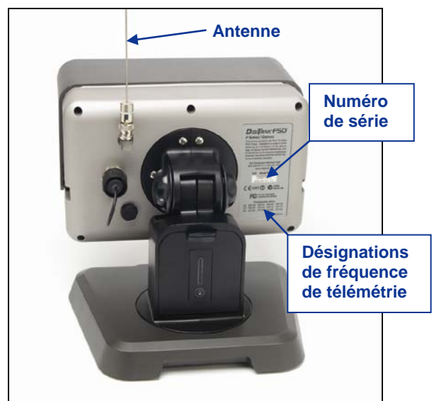
Étiquette de numéro de série à l'arrière de la FSD
