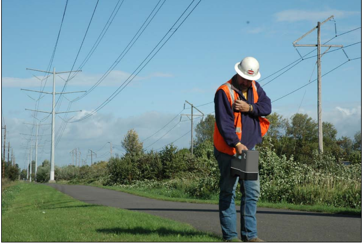
F2 Alıcısıyla Çok Parazitli Bölgede Yer Tespiti
