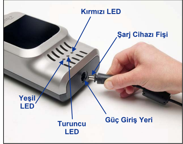
Şarj Cihazı Fişinin Güç Giriş Yerine Takılması
