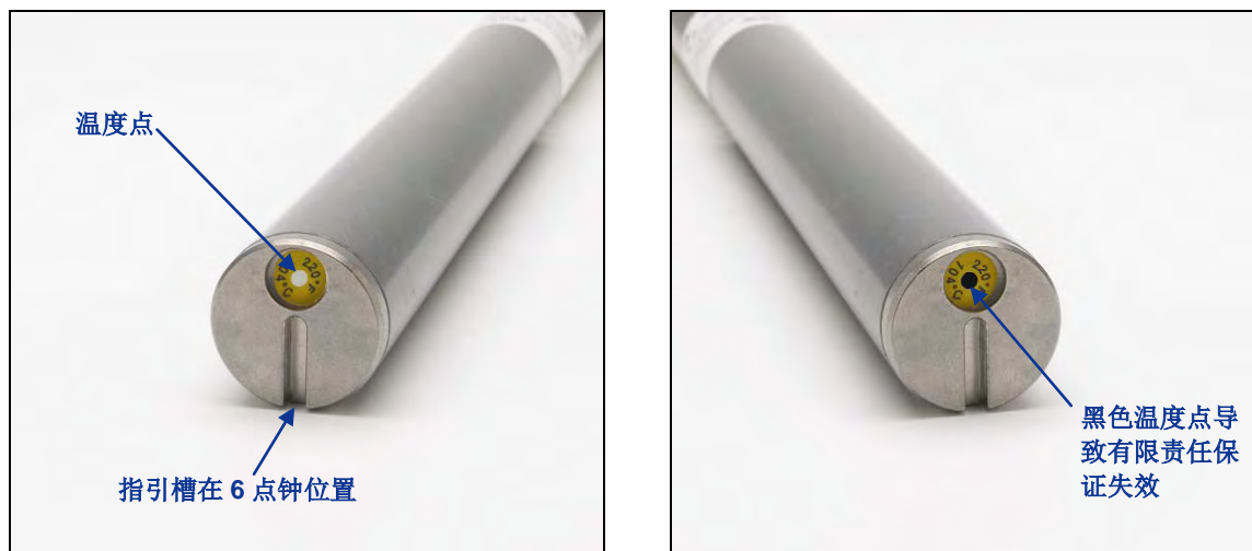
显示出温度点的传感器前端盖、指引槽以及黑色温度点
