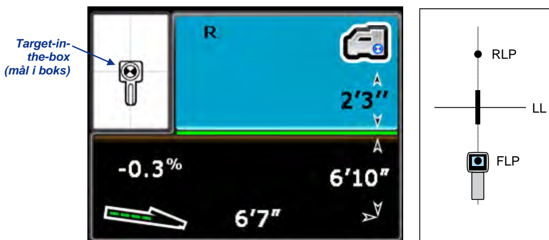
Modtagerens dybdetilstandsskærm (ved FLP med HOJ aktiveret)
