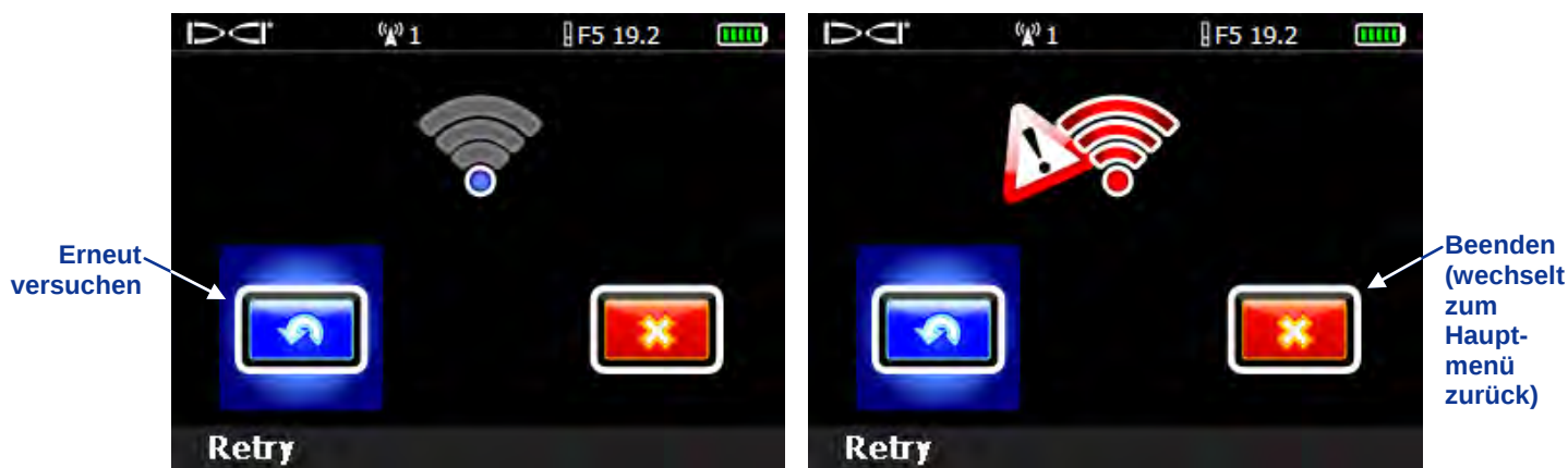
Fehlerbildschirm bei misslungener Kalibration - Signal zu schwach (links) oder zu stark (rechts)
